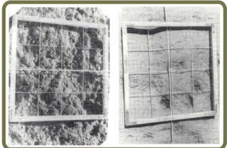
Muestreador para sustrato duro o "caliche" en superficie rugosa y superficie lisa
