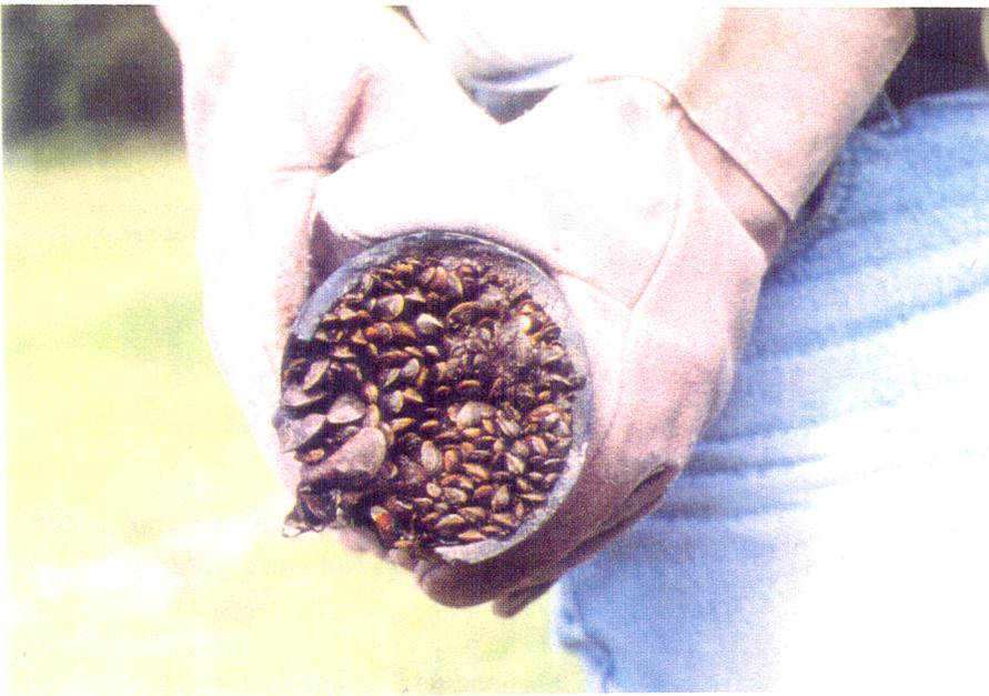
Figura 2. **Fouling** en una sección de tubería metálica (fotografía: N. García Romero).
