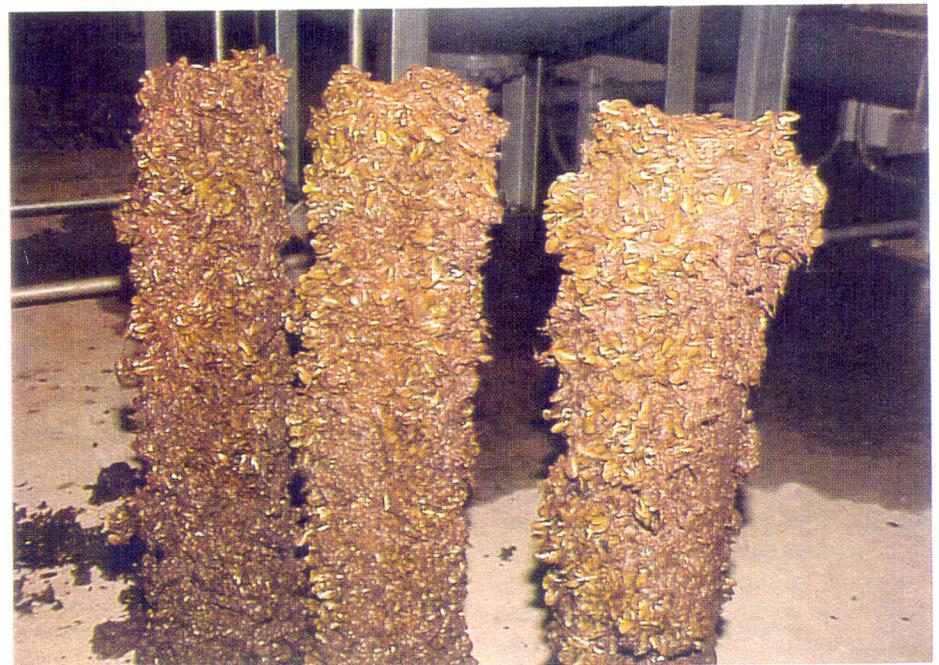
Figura 3b. **Filtro de agua de refrigeración de una unidad generadora de energía (cuenca del Plata), totalmente cubierto por el mejillón dorado.**
